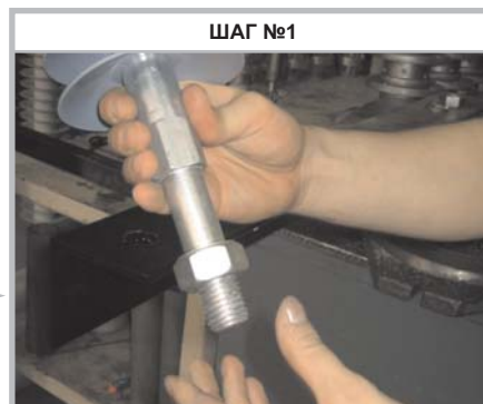
Установите гайку на резьбовую часть изолятора
