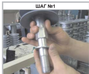
Установите верхнюю плоскую шайбу на изолятор
